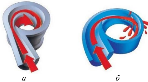
Рисунок 3. Сравнение конструкций камеры питания гидроциклона CAVEX и обычного гидроциклона: а – гидроциклон CAVEX; б – обычный гидроциклон
