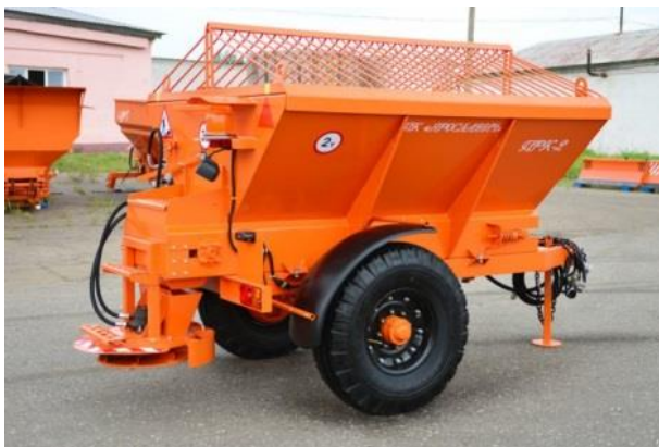
Рисунок 1. Прицепной пескоразбрасыватель с бункером небольшой вместимости
