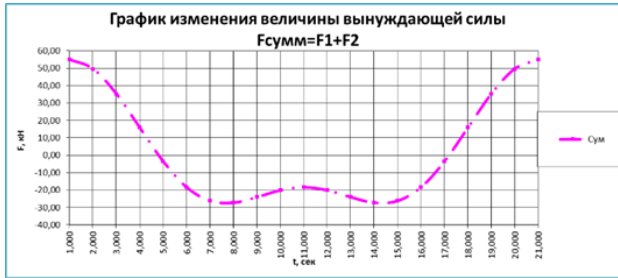
Рис. 2. График изменения величины вынуждающей силы, генерируемой первыми двумя ступенями
