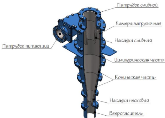
Рисунок 1. Конструкция гидроциклона
