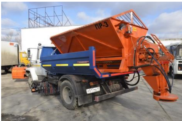
Рисунок 2. Пескоразбрасыватель, устанавливаемый в кузов грузового автомобиля
