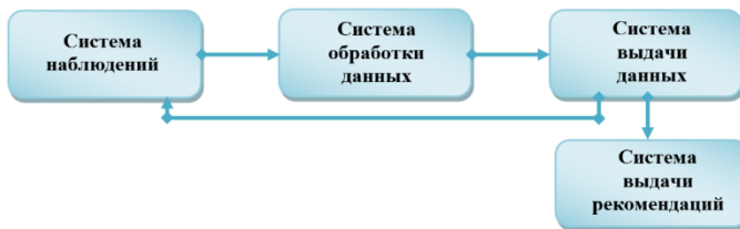
Рисунок 2. Этапы технического мониторинга строительных объектов
