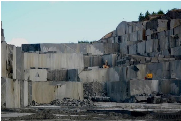
Рисунок 1. Добыча породы камнерезным способом
